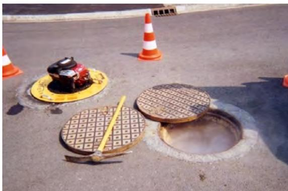
Figure 12-Exemple de tests à la fumée
